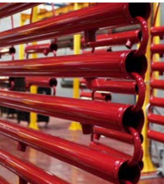
Tubería prefabricada a medida para cada proyecto PCI.
